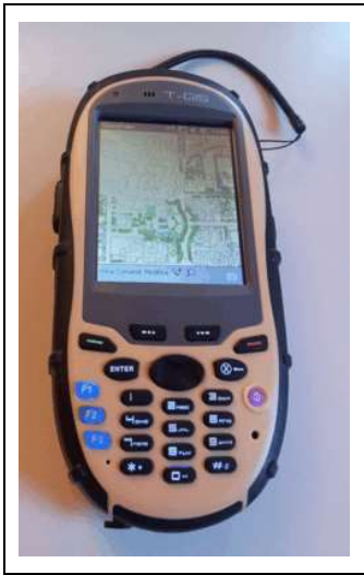
Fig. 2 – Palmare T-GIS utilizzato per applicazione GINVE nel censimento e nella gestione del verde,
